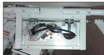
Stecken Sie die Handkurbel durch die Öffnung über dem Drehknauf auf der Motorwelle auf, und drehen Sie sie.
