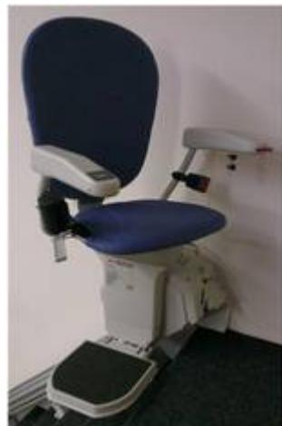
Um in die herkömmliche Fahrtposition zurückzukehren, betätigen Sie einen der Drehsitzhebel (10) und drehen in entgegengesetzte Richtung. Stoppt die Drehung können Sie den Hebel loslassen, um die Position zu arretieren. Der Sitz dreht sich nur am oberen Ende der Schiene. Betätigen Sie Drehfunktion während der Fahrt, stoppt Ihr Lift.
