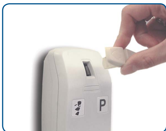
Abb. 2/25: Bedienhebel des Außenbefehlsgebers einsetzen
